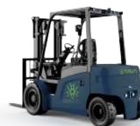
CPD50L1 Capacidade 5 T Altura de elevação 3000-6000mm Bateria de lítio Controlador AC
