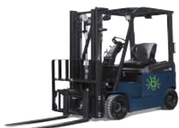
CPD15/20L1 Capacidade 1,5/2 T Altura de elevação 3000-5000mm Bateria de lítio Controlador AC
