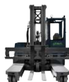
MQC40 Capacidade nominal 4000kg Altura máxima de elevação 8000mm
