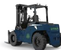
EFL803/1003-HV Capacidade 8/10 T Altura de elevação 3000-7000mm Bateria de lítio Controlador AC
