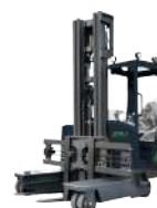
MQC25 Capacidade nominal 3000kg Altura máxima de elevação 8000mm
