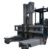
MQC50 Capacidade nominal 5000kg Altura máxima de elevação 8000mm
