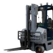
MQK30 Capacidade nominal 3000kg Altura máxima de elevação 8000mm
