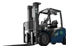
CPD25/38 H4 Capacidade de 2,5 T a 3,8 T Controlador ZAPI Bateria de lítio
