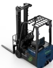
CPD15/18/20/25/30/35/38 Capacidade de 1,5 T a 3,8 T Altura de elevação 3000-7000mm Bateria de lítio
